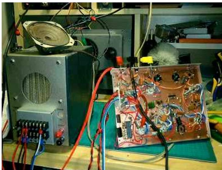
左のボックスは、ジャンクのレベルメータを外して内部に電源回路とスピーカを実装したもの。ボックスの上は壊れかけたスピーカ。6AR5出力はとりあえずこのスピーカを接続。
